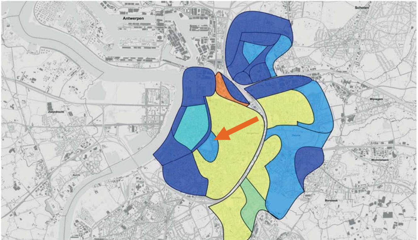
Figuur 34: Felblauwe zones: optimaal gescheiden rioleringssysteem; Lichtblauwe zones: gescheiden systeem met primaire aansluiting op een buffer zoals een parkvijver of grote waterpartij; Turquoise zone: pragmatisch gescheiden stelsel op basis van projectniveau; Lichtgroene zones: optimaal gemengde afvoer met infiltratie van alle neerslag; Gele zones: optimaal gemengde afvoer met voldoende buffering om een belangrijk deel van de neerslag lokaal te infiltreren; Oranje zones: gemengde afvoer met weinig potentieel op het vlak van infiltratie
