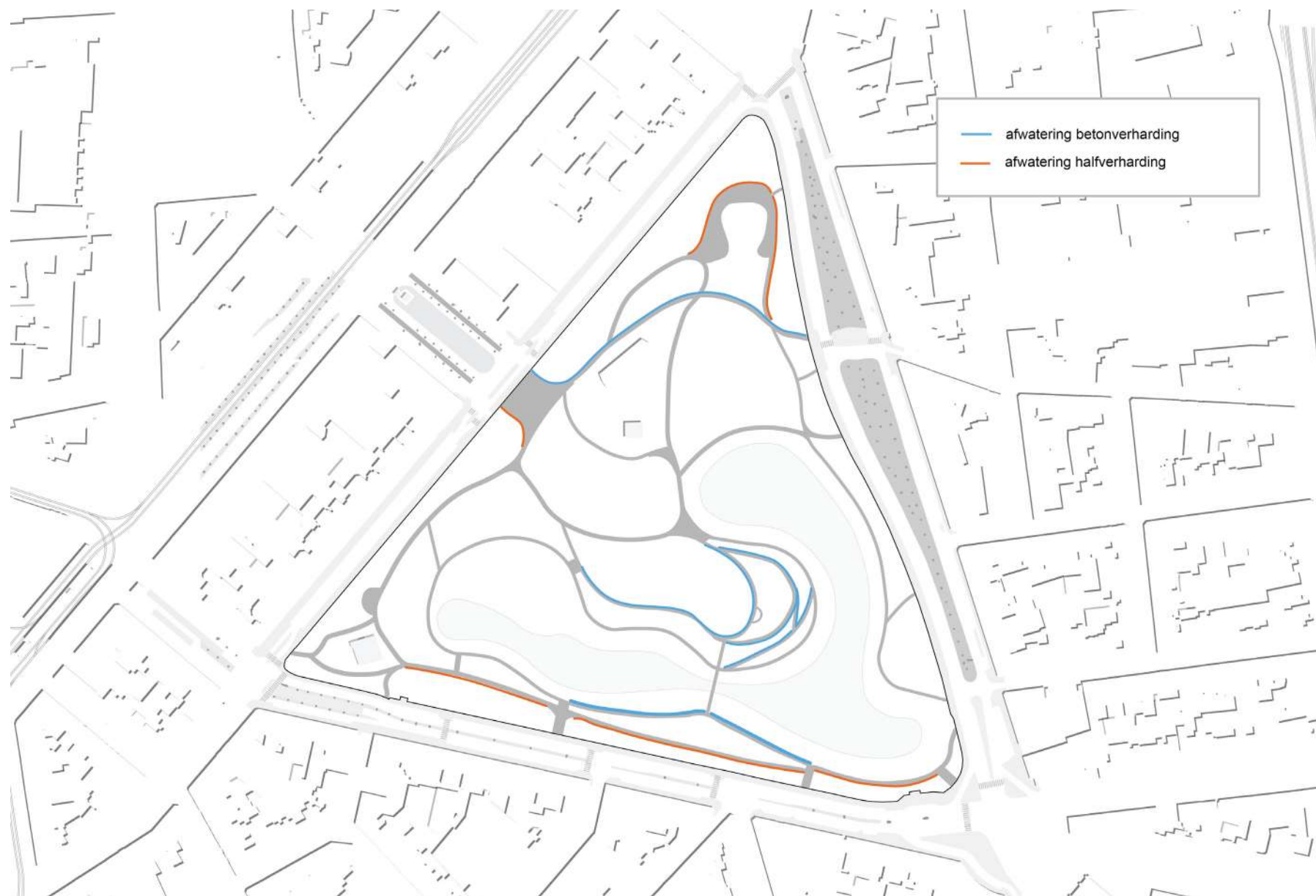
Figuur 3 te voorziene afwatering verharding
