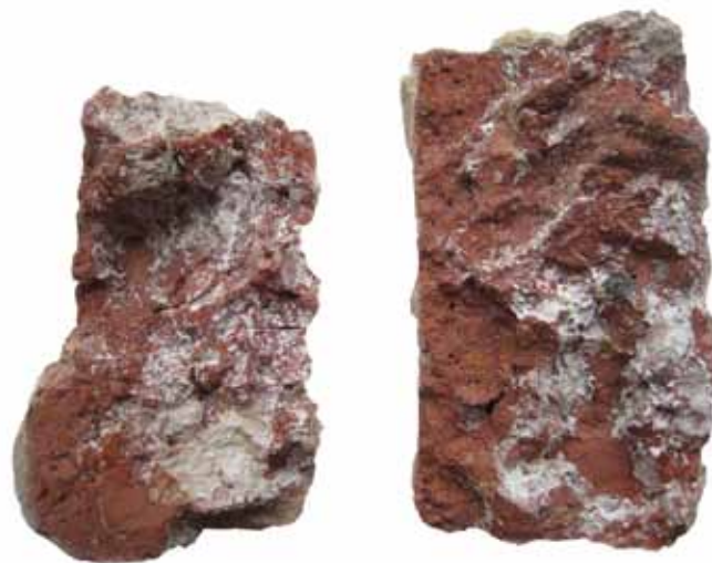
Fig. 20. Macroscopische opname: kalkrijke vlekken in Terhagen klei
