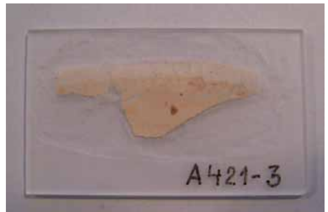
Fig. 11. Macro opname: slijpplaatje krijtsteen van Lézennes, A421-3
