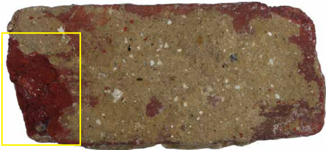
Fig. 18. Het hoge ijzergehalte in de klei en de hoge temperatuur tijdens het bakken, kleuren de baksteen felrood.
