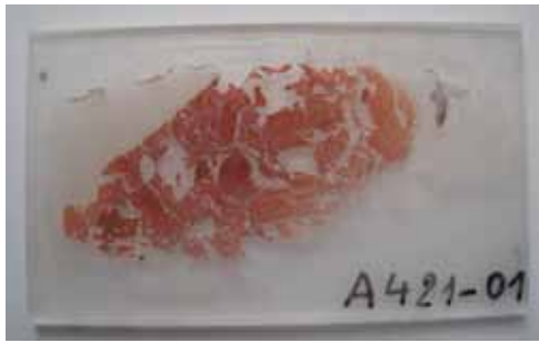
Fig. 22. Macro opname dunne doorsnede van baksteen
