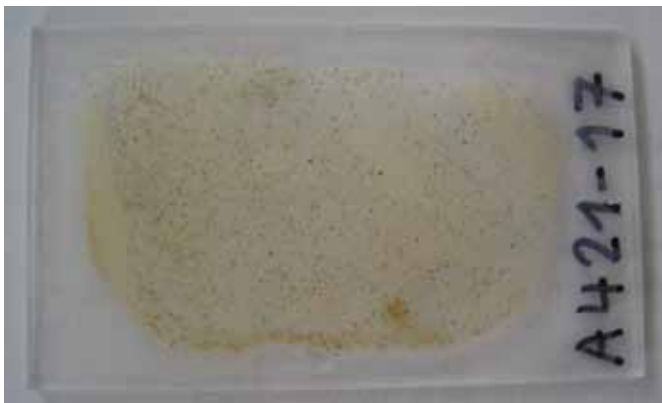
Fig. 45. Macro opname: dunne doorsnede Brusseliaanse steen, Gobertange variant
