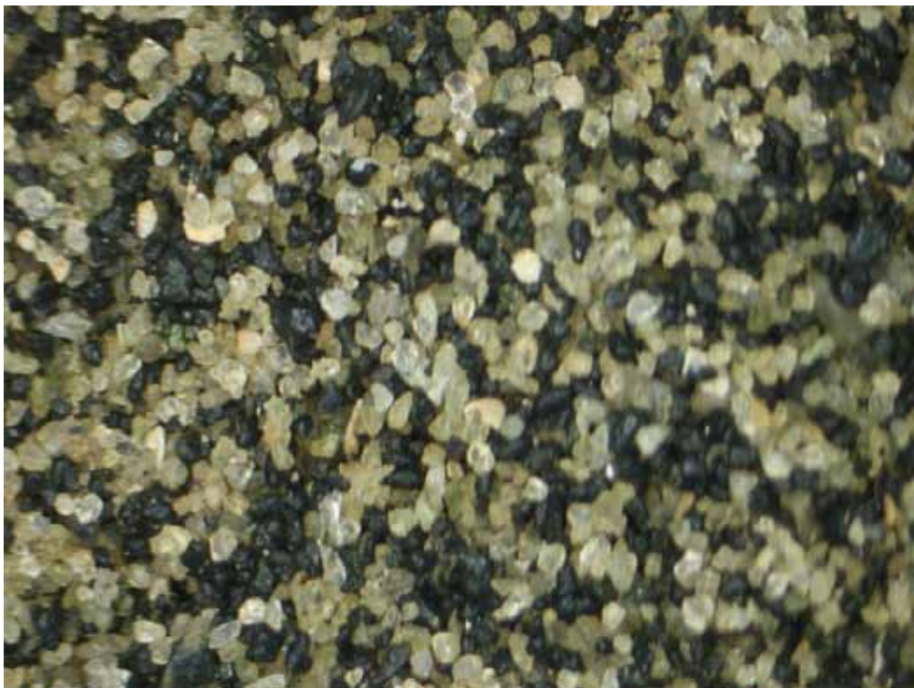
Fig. 3. Zeefstaal van het zwarte zand: groene en zwarte glauconietkorrels, doorschijnende kwartskorrels (helder); korrelgrootte 0,125 - 0,265 mm
