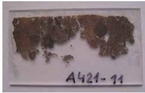
Fig. 22. Macro opname dunne doorsnede van baksteen
