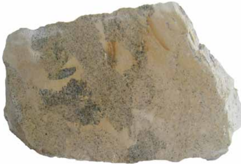
Fig. 44. Vlakgeschuurd breukvlak Brusseliaanse steen, Gobertange variant, face 1; brede graafgang opgevuld met fijne kwartskorrels en groen tot bruingroen glauconiet; de kleinere graafgangen zijn opgevuld met een grovere zandfractie.
