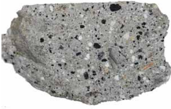
Fig. 62. Vlakgeschuurd stukje trasmortel waarin houtskool (grote zwarte inclusies), vulkanische mineralen (zwarte spikkels), hoekige kwartskorrels, krijtinclusies (witte vlekken), hoekige fragmenten van gesteenten en vulkanische tuf (asgrijze cement), 3,2 x 2,3 cm
