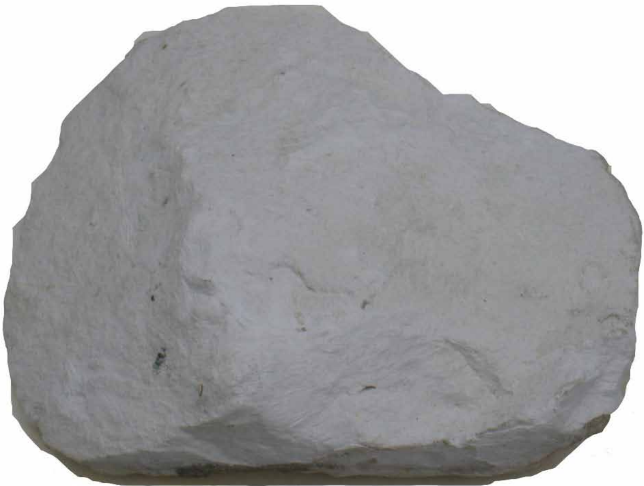
Fig. 10. Zeer zachte, witte, fijnkorrelige, homogene krijtsteen, A421-M65, spoor 66, face 1; Bte: 21 cm
