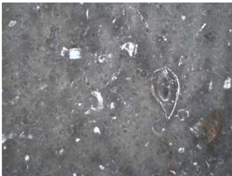
Fig. 16. Kleine vierkante holte mogelijk van een opgeloste bioklast; bruin hoekig fosfaatinsluitel (mogelijk visschub) en doorsnede van (spitvormige) inoceramus. Ook rechthoekige tot ruitvormige holtes komen voor in het slijpplaatje A421-3; doorvallend licht.
