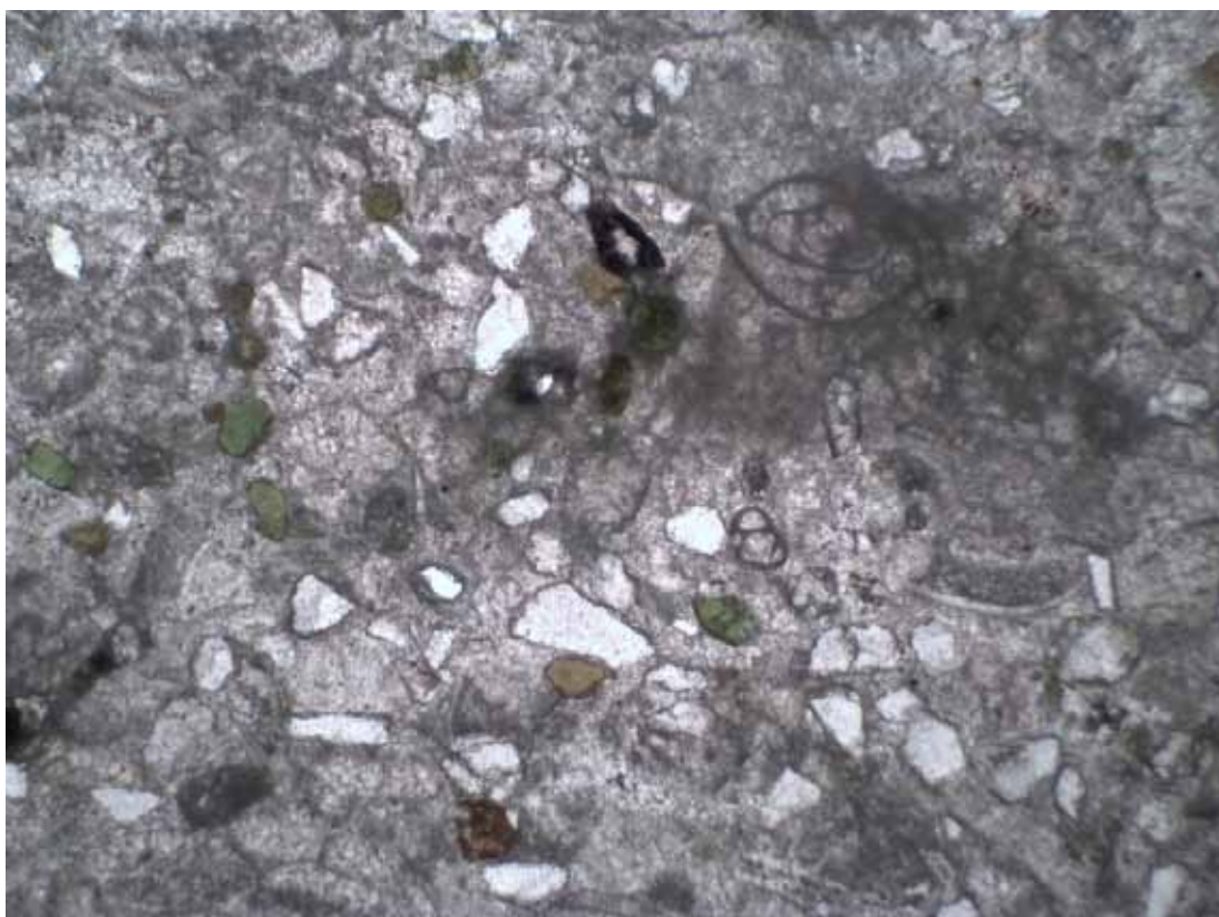
Fig. 32. Microscopische opname dunne doorsnede: kalkmatrix met hoekige kwartskorrels, groene glauconietkorrels, dunwandige schelpen en miliolide; doorvallend licht
