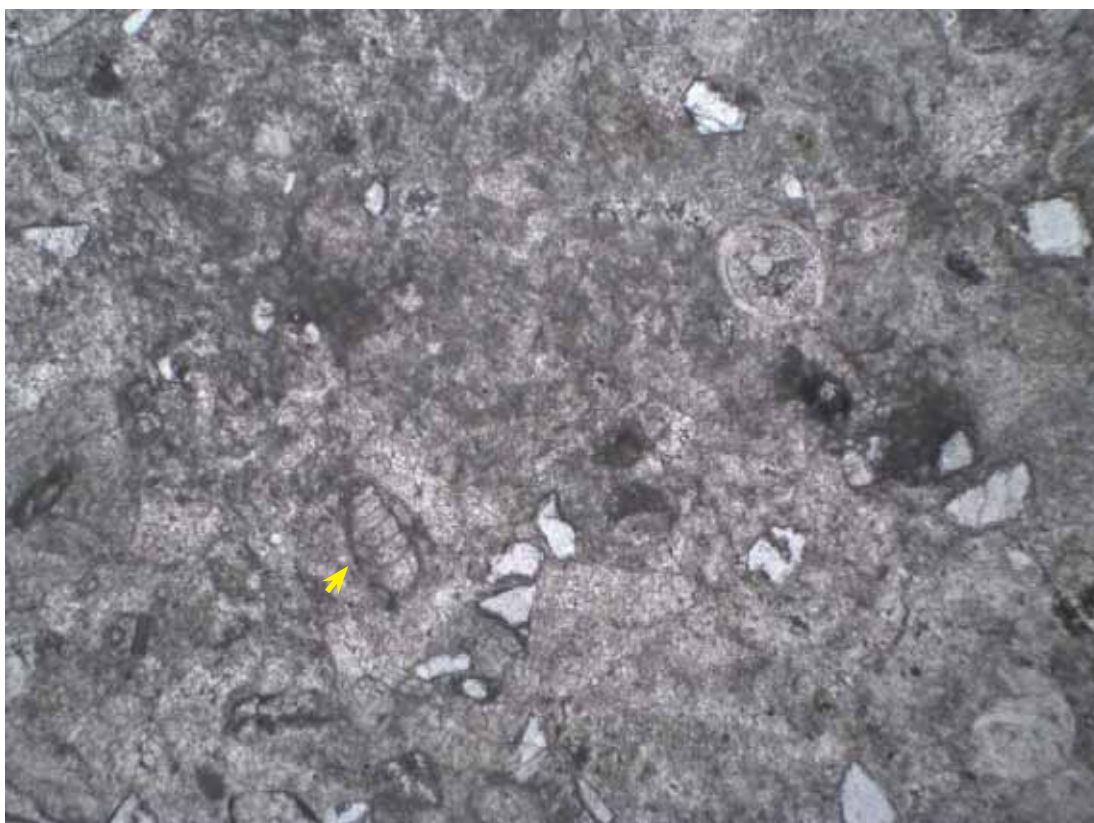
Fig. 33. Microscopische opname dunne doorsnede: kalkmatrix met hoekige kwartskorrels, fragment van kalkkokerworm; doorvallend licht
