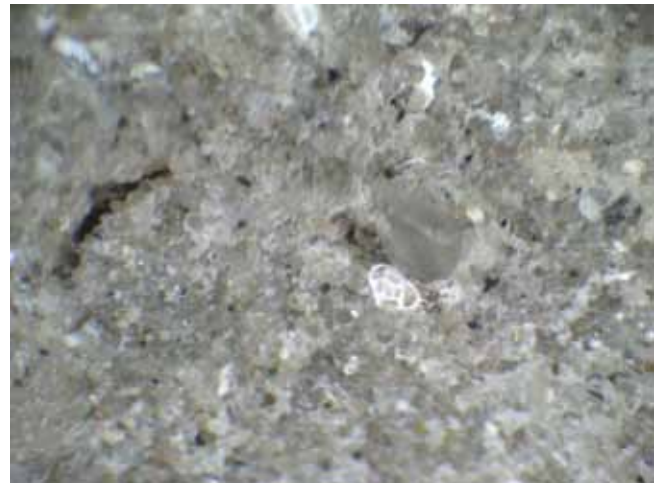
Fig. 30. Microscopische opname: fossielgruis, foram, opgeloste holte van schelp en glimmer
