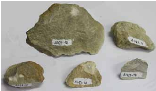
Fig. 38. Monsters Brusseliaanse steen uit het parement, face 1
