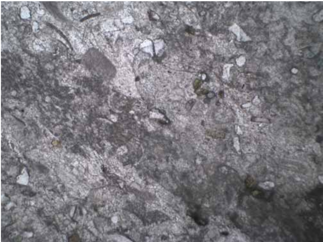
Fig. 35. Microscopische opname dunne doorsnede: kalkmatrix met donker spoor van graafgang (bioturbatie), waarin zeer weinig of bijna geen kwartskorrels en bioklasten; doorvallend licht
