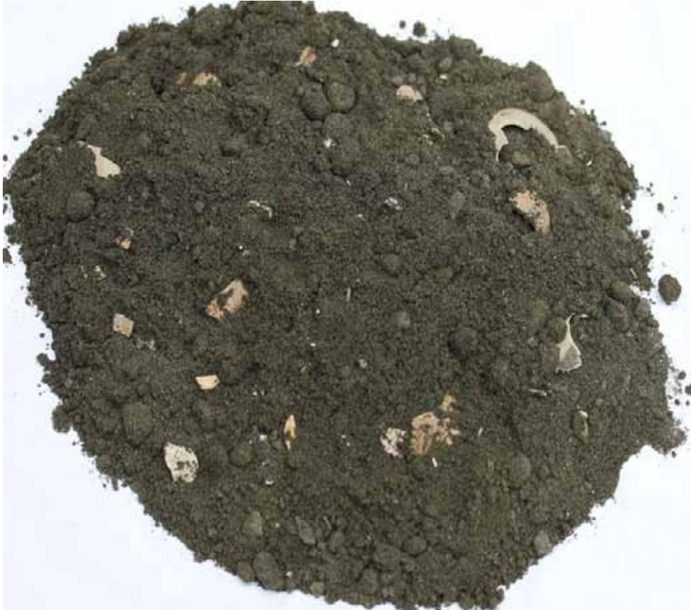
Fig. 2. Grondmonster onder de krijtsteenblokken. Het zwarte Zand van Antwerpen is zeer glauconietrijk (> 60%), bevat veel kwartskorrels, kleimineralen en kenmerkende gidsfossielen (schelpen), A421-M66, face 1.
