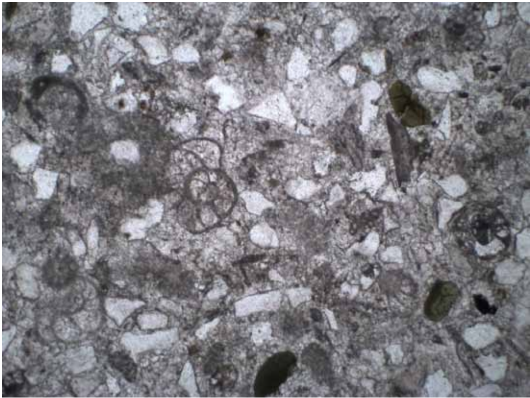
Fig. 34. Microscopische opname dunne doorsnede: kalkmatrix met slecht gesorteerde hoekige kwartskorrels, bruingroen verweerde glauconietkorrels en kenmerkende foraminiferen
