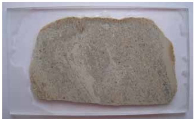
Fig. 46. Macro opname: vlakgeschuurd monster; bemerk de fijnzandige matrix waarin mergelige banden
