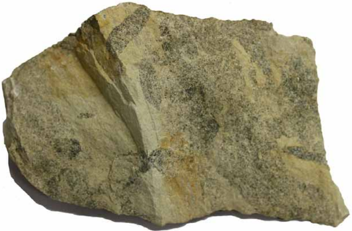
Fig. 43. Breukvlak Brusseliaanse steen, Gobertange variant, face 1, spoor 38; bemerk de mergelkleurige en bleekbeige lenzen waarin graafgangen opgevuld met donker glauconietrijk zand (13 x 8 cm).
