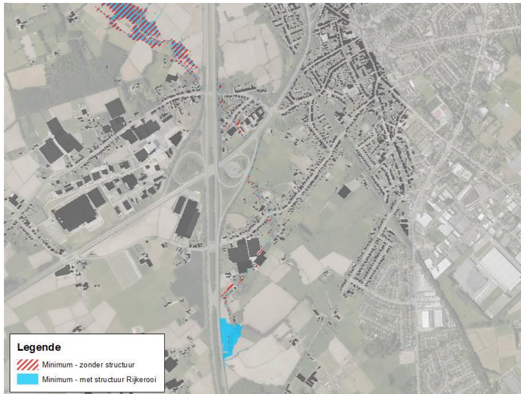
Figuur 5: Overstromingscontouren bij het minimale klimaatscenario met en zonder implementatie van het GOG Rijkerooi.
