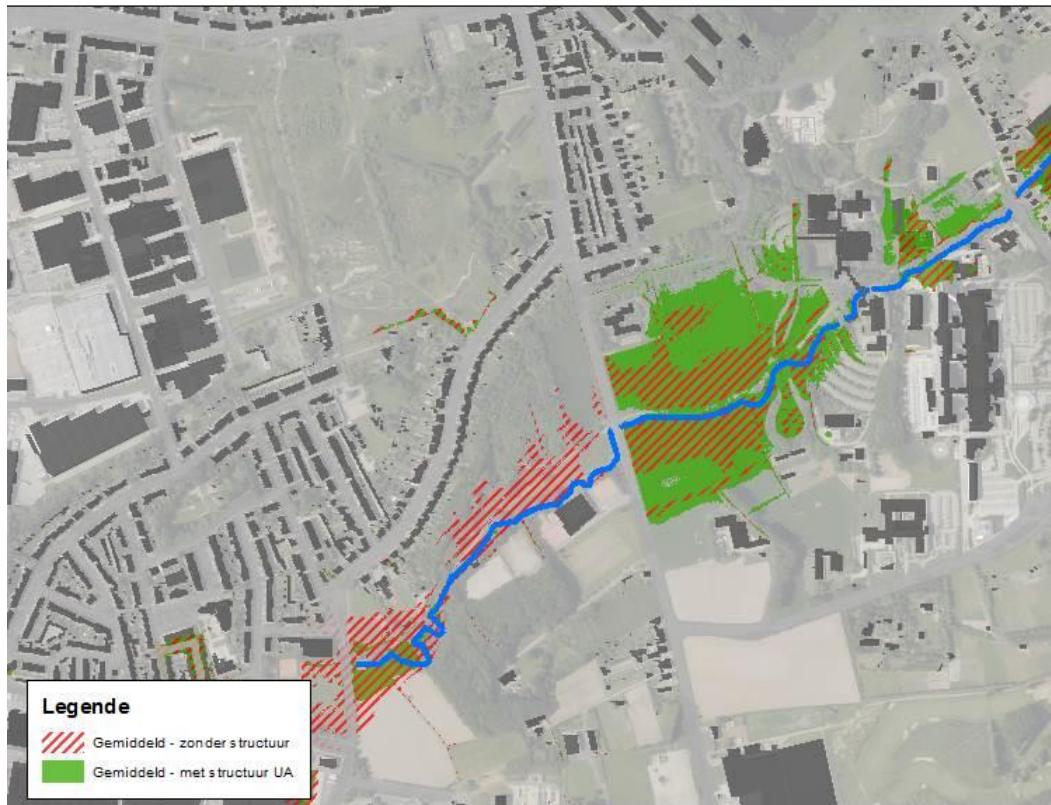
Figuur 18: Overstromingscontouren bij het gemiddelde klimaatscenario met en zonder implementatie van het GOG Drie Eycken .
