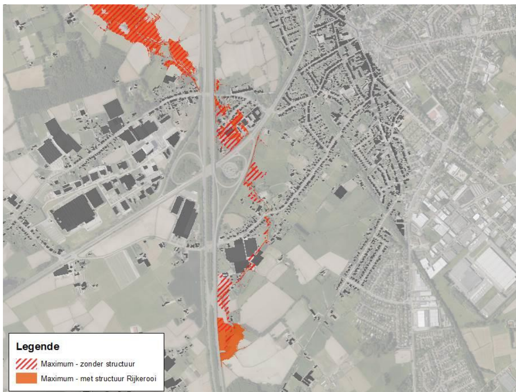
Figuur 7: Overstromingscontouren bij het maximale klimaatscenario met en zonder implementatie van het GOG Rijkerooi.
