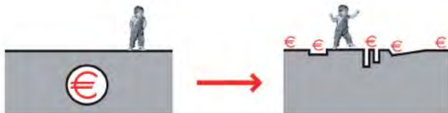
Figuur 10-1: Duurzaam stedelijk waterbeheer zet best in op een groot aantal, kleine/goedkope en duurzame, oorzaak-wegnemende opwaartse bronmaatregelen i.p.v. een beperkt aantal, dure, technische maatregelen in of afwaarts het stedelijk waterafvoersysteem.
