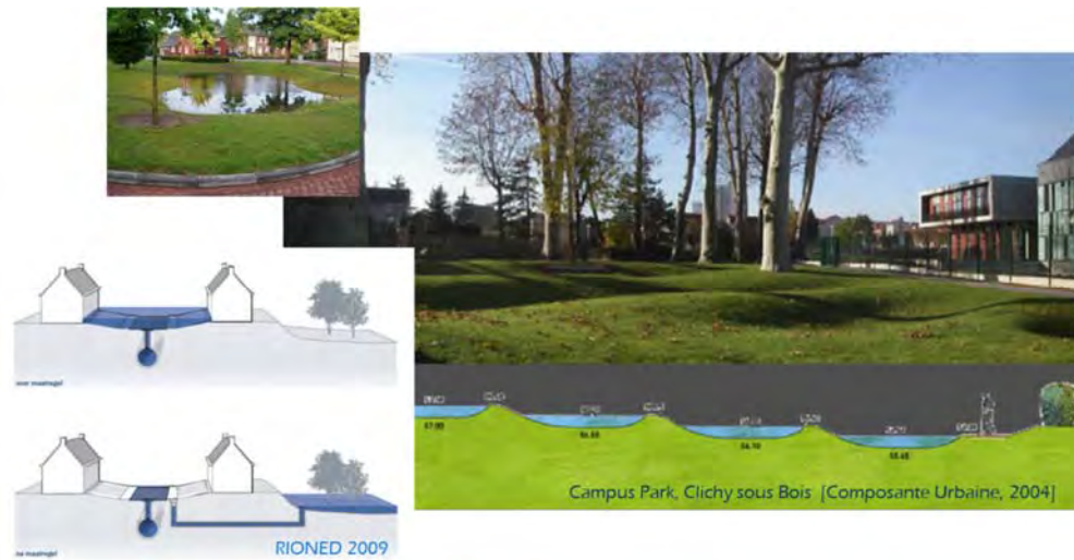
Figuur 10-9: Realiseren van bijkomende opwaartse berging en infiltratie door doordacht aanleggen van lokale depressies in openbaar terrein, vb. wadi's, als voorbeeld van bronmaatregelen en kernelementen in duurzaam stedelijk waterbeheer
