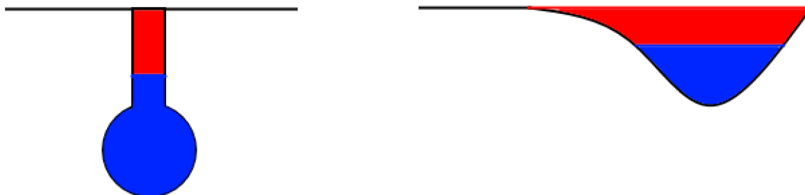
Figuur 51: De reservesectie (rood) bij overschrijden van ontwerpdebieten (blauw) is veel kleiner bij gesloten systemen dan bij open systemen.
