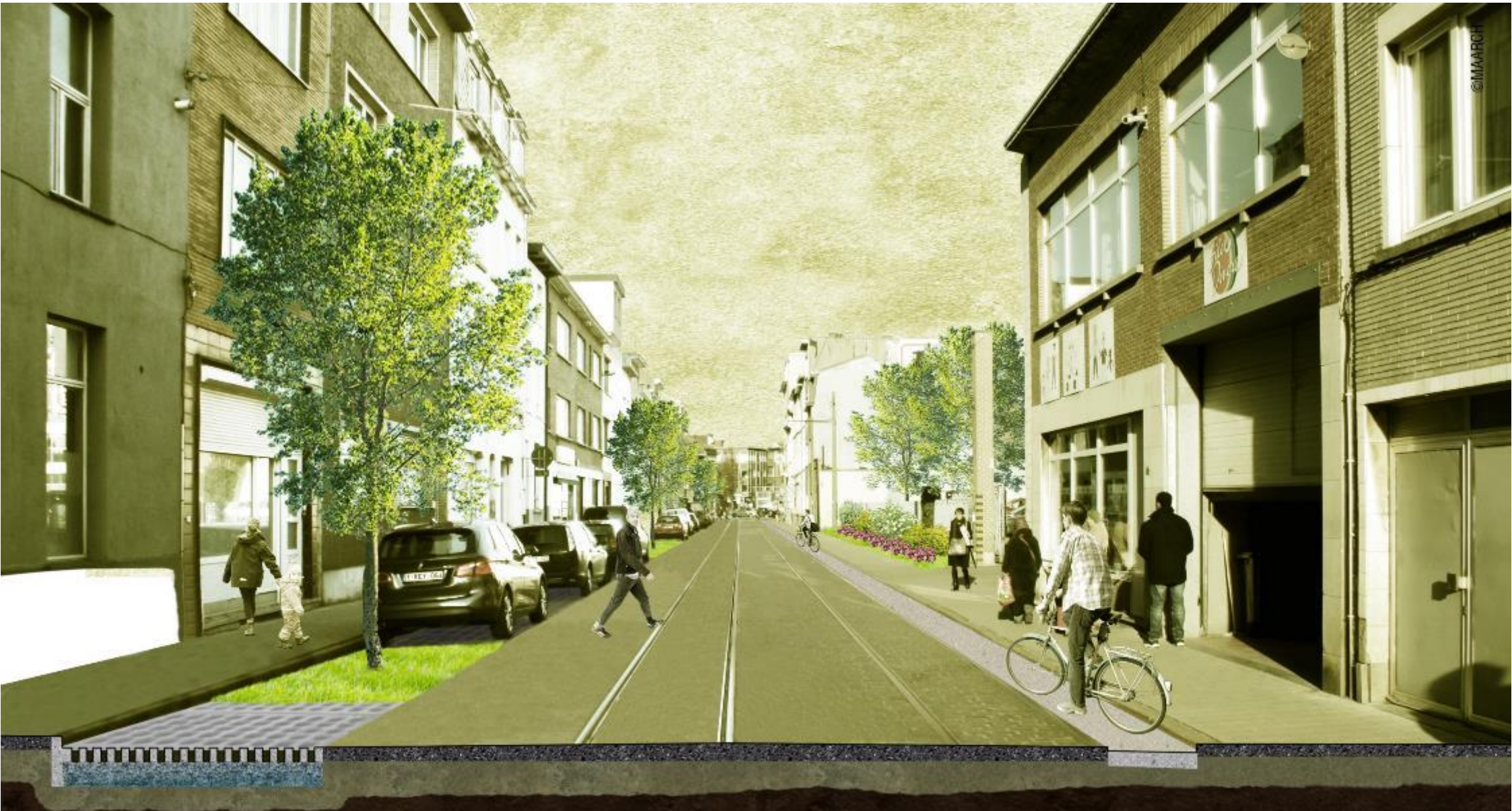
Figuur 18: Een smalle woonstraat, met een doorvoerfunctie en tramsporen. Ruimte creëren voor water vormt hier een uitdaging. Een deel van de weg werd verlaagd aangelegd in een poreus materiaal, zodat water zich daar kan verzamelen en de grond kan intrekken. De grootste volumes worden echter gebufferd onder de parkeervakken. Waar mogelijk, zoals ter hoogte van de insprong aan de rechterzijde, wordt de verharding gebroken met extra groen.
