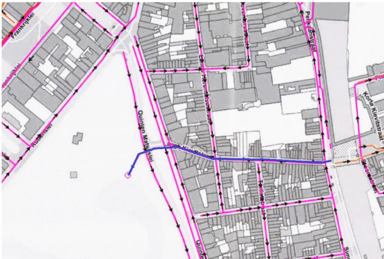
Figuur 4-4. RWA-leiding aan Lange Kievitstraat (blauwe streng) – ook afvalwater van woningen is hierop aangesloten waardoor lozing op vijver van het Stadspark niet in gebruik is
