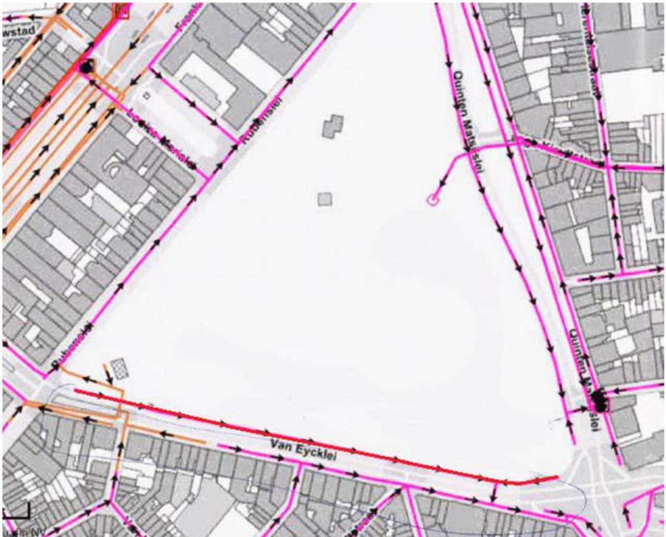
Figuur 4-3. Gemengde rioleringsleidingen, enkel in functie als regenwaterafvoer (RWA) via straatkolken, t.h.v. Van Eycklei (rode strengen)
