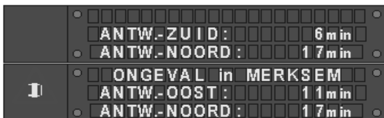
Figuur : Voorbeeld van dynamische verkeerssignalisatie (bron: VVC)
