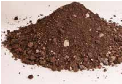
lichtgewicht extensief mineraal daktuinsubstraat 40-50 mm
