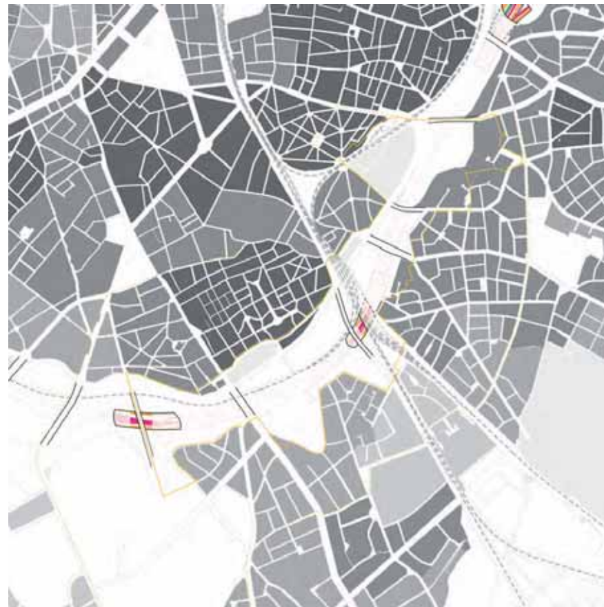
Schema voor de openingen in een fase van volledige overkapping. Deze zijn geplaatst om het minst hinder op de omgeving te hebben, aar men het verst van de snelweg zit. En waar overkappen technisch het meest complex is (en minst ruimtelijke toegevoegde waarde geeft)
