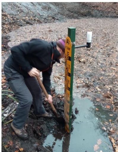
Figuur 4-4 : Aanpassingen meetlatten aan extreem lagen oppervlaktewaterstanden
