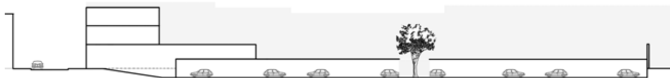
Voorbeelddoorsnede doorheen de kavel van het Volkshuis in een scenario met half-ondergronds parkeren
