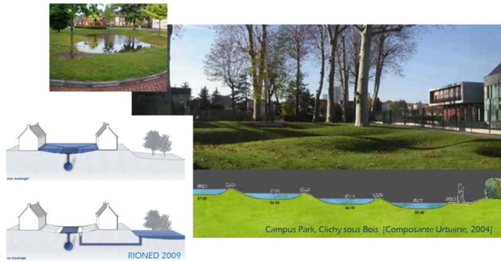
Figuur 21: Realiseren van bijkomende opwaartse berging en infiltratie door doordacht aanleggen van lokale depressies in openbaar terrein, vb. wadi's, als voorbeeld van bronmaatregelen en kernelementen in duurzaam stedelijk waterbeheer
