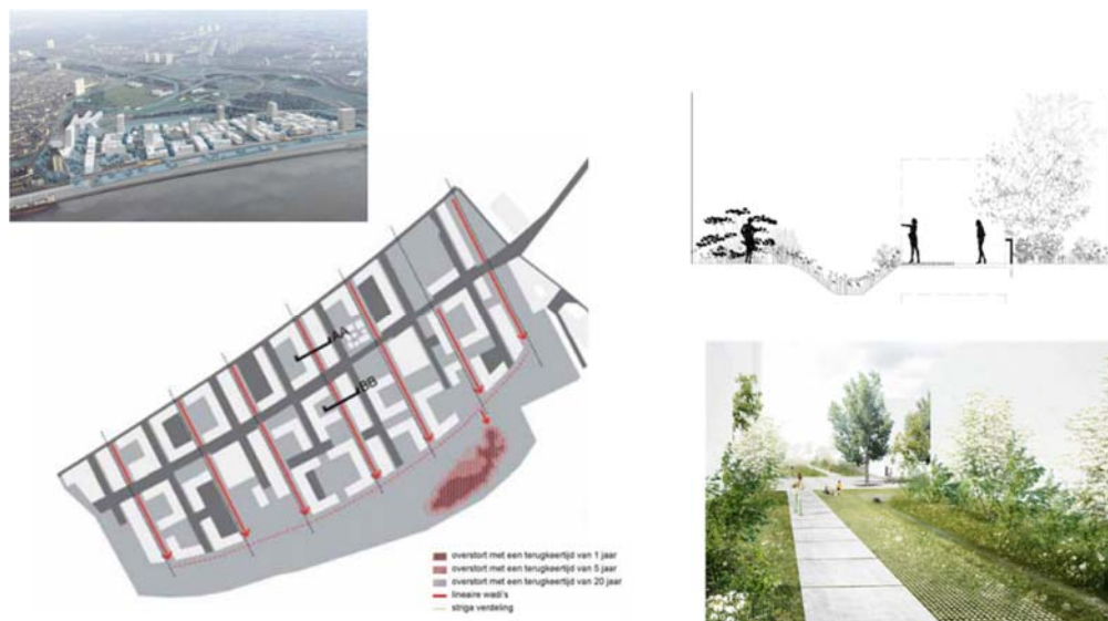
Figuur 22: Wijkontwikkeling Nieuw Zuid, Antwerpen: Hemelwater volledig bufferen en maximaal infiltreren op de site
