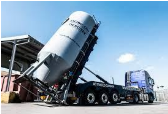
Afbeelding 3.20 Actieve koolfilter in transport, type Mobicon Desotec
