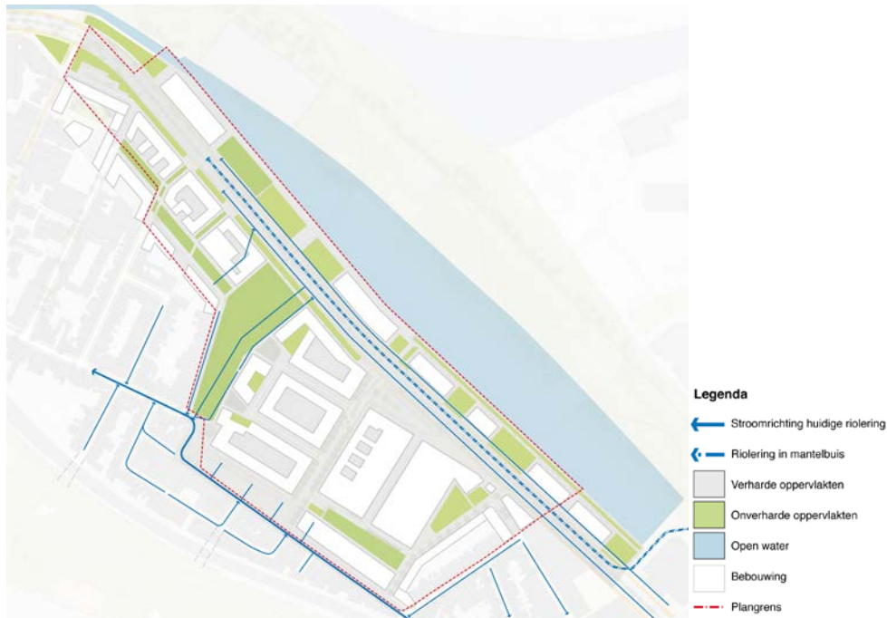
Bestaande droogweerafvoer (Startadvies Slachthuisite, Riolink NV).
