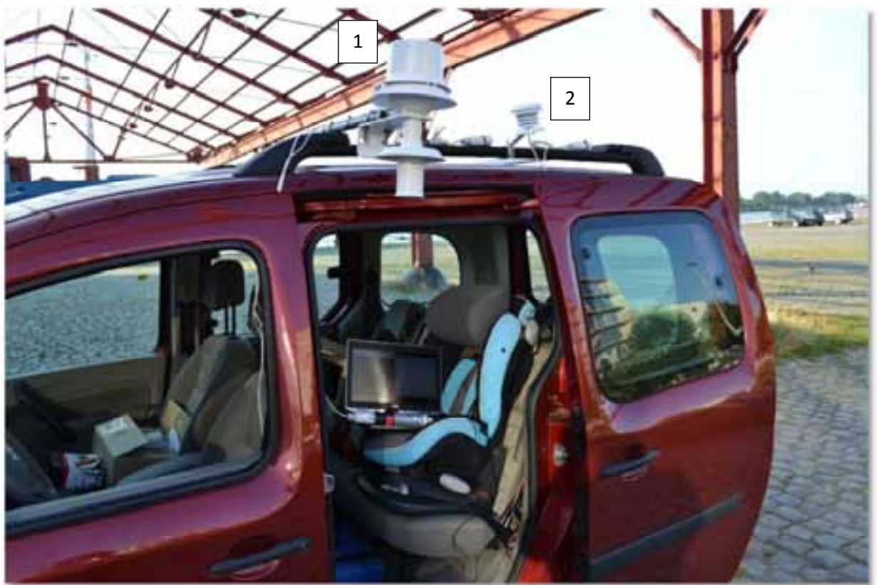
Figuur 19 : Actief en passief geventileerde luchttemperatuursensoren, gemonteerd op een voertuig. Als sensoren zelf maakten we telkens gebruik van dezelfde HOBO U23-002 loggers die we (1)
