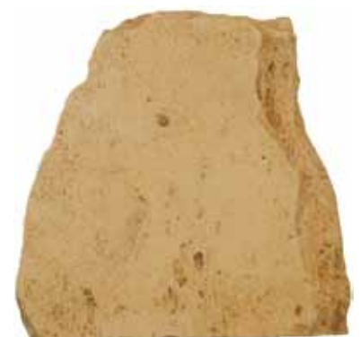
Afb. 4. Breukrand van een biscuittegel waar aan het oppervlak een dun laagje engobe zichtbaar is.
