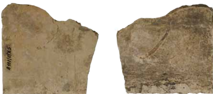
Afb. 3. Links: met engobe bedekte effen voorzijde van een biscuittegel; rechts: de ruwe rugzijde van dezelfde tegel.
