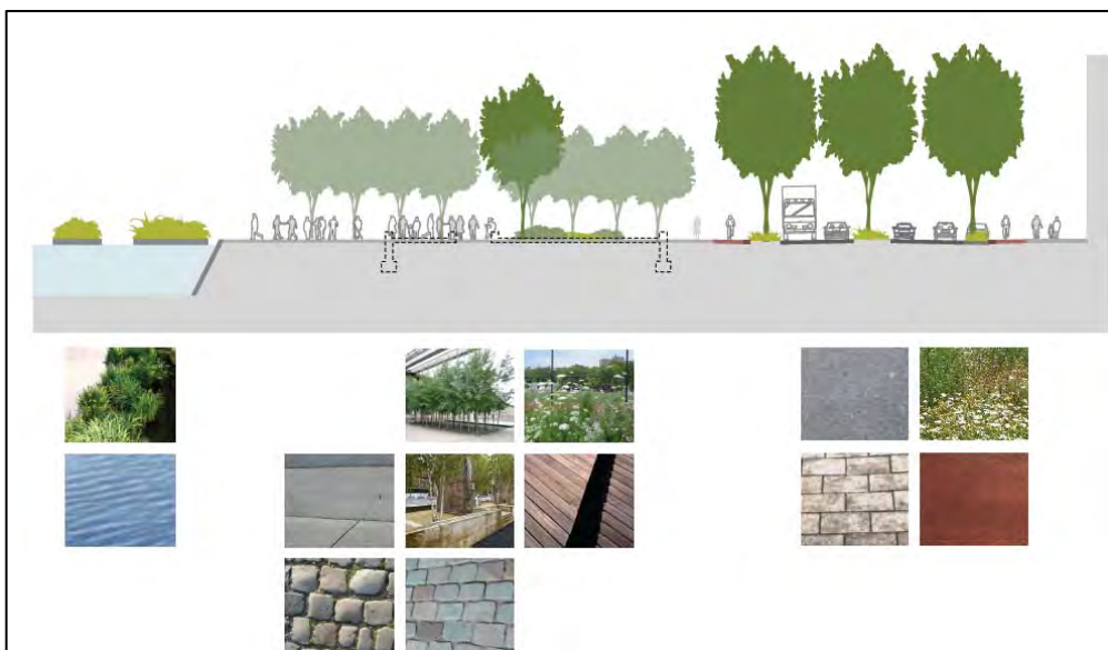
Figuur 73: Illustratieve doorsnede met materiaalgebruik per deel, bron: TV MAKH
