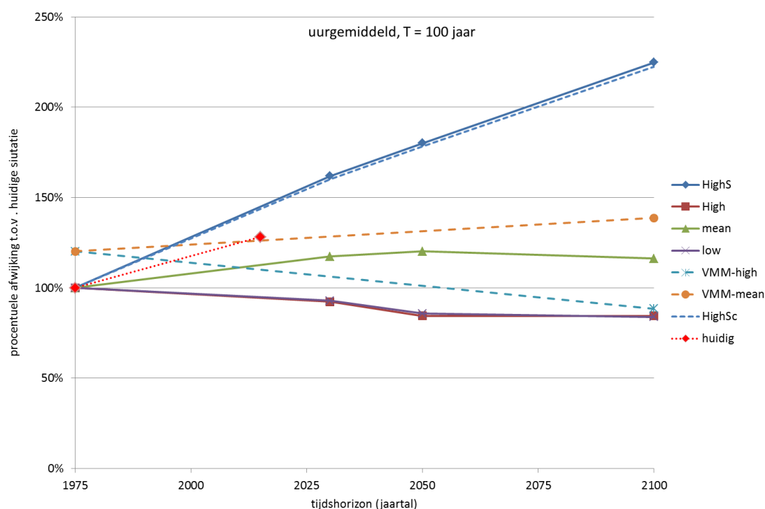
Figuur 8: Vergelijking van de ruimtelijk gecorrigeerde uurgemiddelde neerslag (HighSc) versus de originele HighS scenario's voor Benedenvliet. Vergelijking van de inschatting voor de huidige toestand (rode ruit) t.o.v. de andere klimaatscenario's en tijdshorizonten voor de uurlijkse neerslagintensiteiten bij een terugkeerperiode van 100 jaar.
