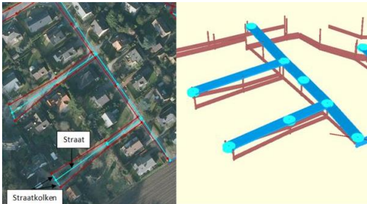
Figuur 16: Voorbeeld van invoer straatlaag als 1D laag in het model.
