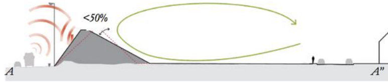
Geluidswal Polygoonstraat: asymmetrisch profiel i.f.v. geluid en parkbeleving
