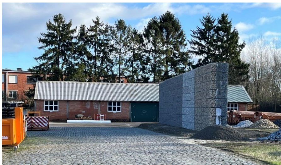
Figuur 1 - Proefopstelling van geluidswerende wanden voor het Pomppark Zuid in 2024 (© AG Vespa).
