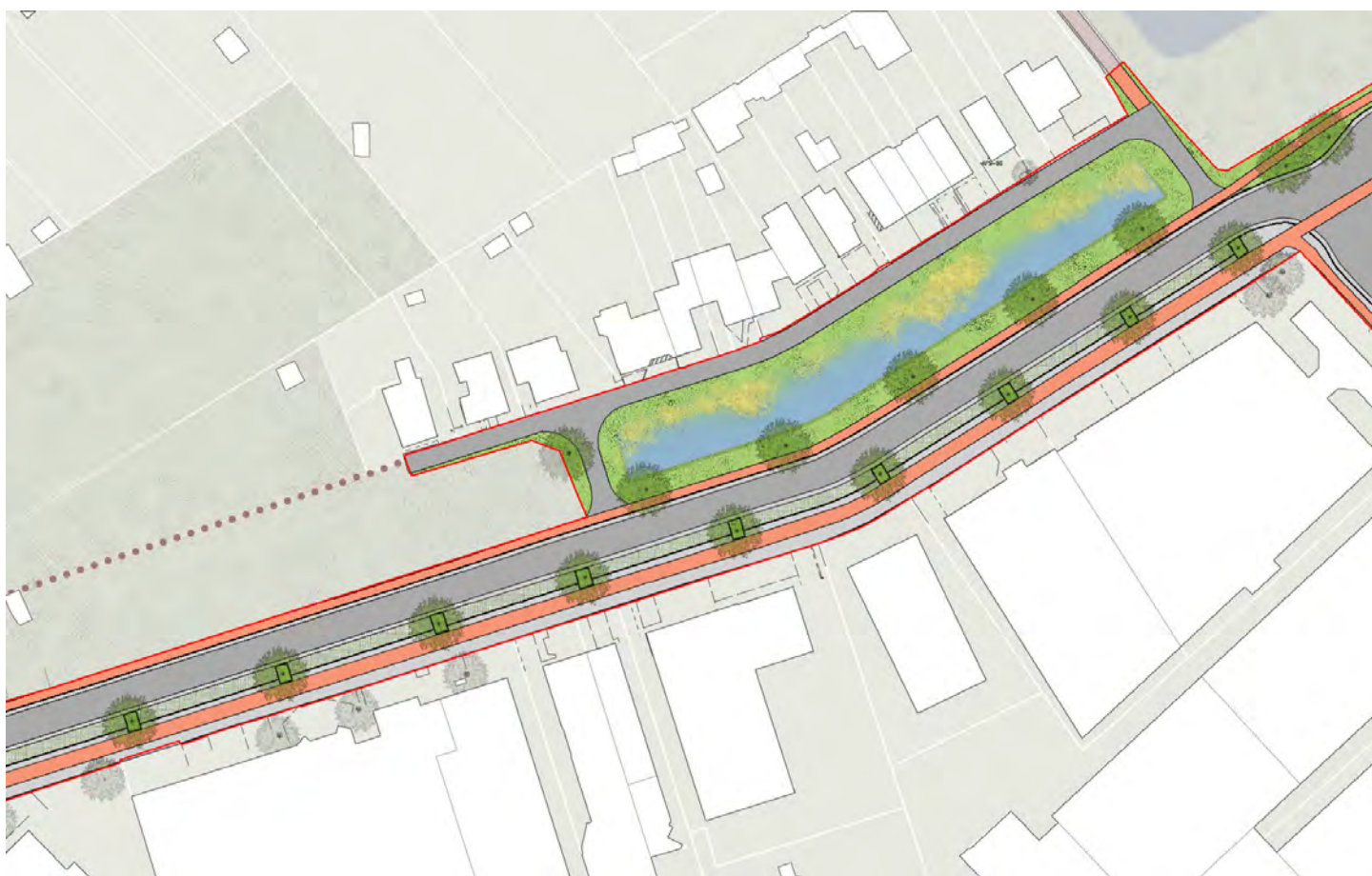
Schetsontwerp plasberm en opvangbekken aan het woonerf Moerelei in het kader van de wegenis- en rioleringsstudie.
