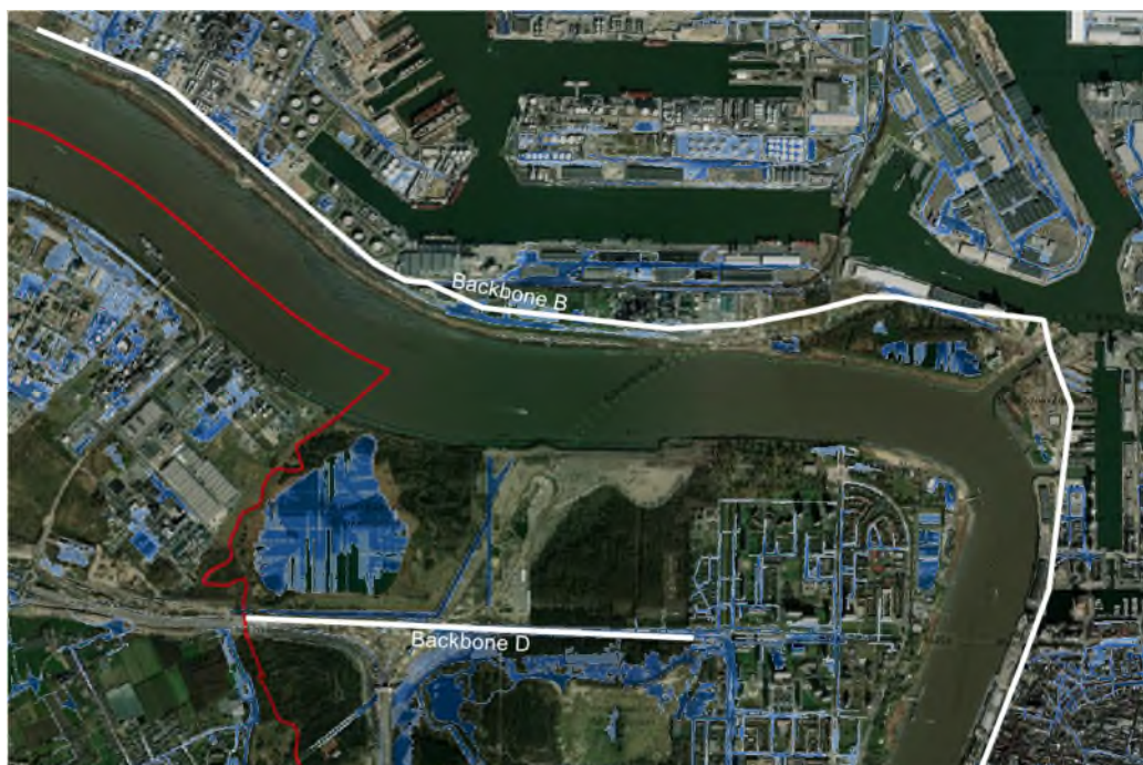
Figuur 35: Pluviale overstromingsgevoeligheid t.h.v. backbone D en noordelijk deel van backbone B.
