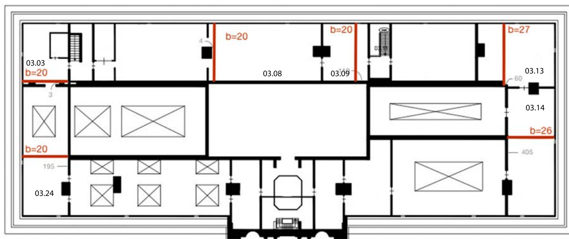
Afbeelding 79: plan met aanduiding verloop keulse goten
