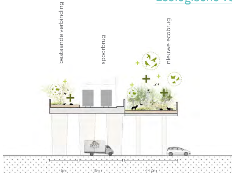
Eco-brug aan de spoorbrug over de ring
